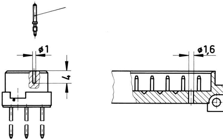
Zur Unverwechselbarkeit mehrerer Steckverbinder nebeneinander ist eine Kodierung erforderlich. Messerleiste an vorzentrierter Stelle nach Skizze aufbohren. In Federleiste Kodierstift 09 06 000 9950 mit Setzwerkzeug 09 99 000 0103 in vorhandene Bohrung einsetzen.
