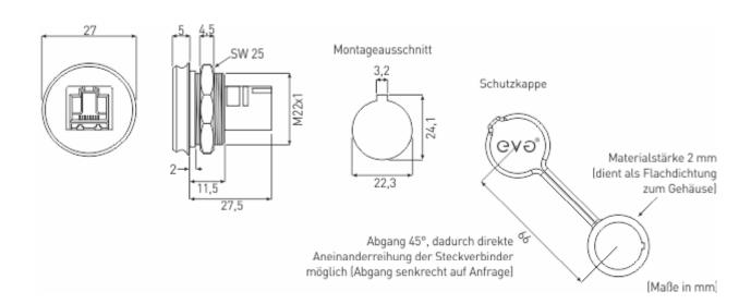
M22 Gerätedose Frontmontage mit Adapter Buchse RJ12
