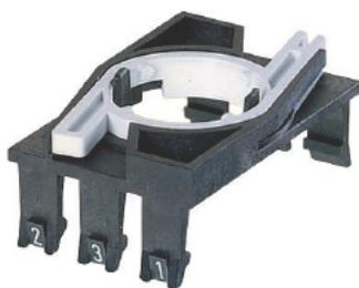
Lampenfassung und Schaltelemente werden zunächst in die Kupplung eingearastet. Die komplette Einheit wird dann auf das Betätigungselement aufgerastet. Zum Lösen muss der Bajonethelbel gedrückt werden (gleichzeitig Sicherung gegen unbeabsichtigtes Lösen).
