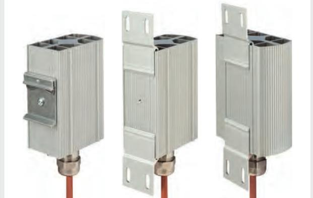
Die Heizungen können mit Clip auf einer DIN-Hutschiene angebracht oder mit Schraubflanschen fest verankert werden. Die universalen Schraubflansche passen auf jede Heizungsgröße und können werkzeuglos in das Heizungsprofil eingeschoben werden. Dadurch ist eine schmal- oder breitseitige Montage möglich.
